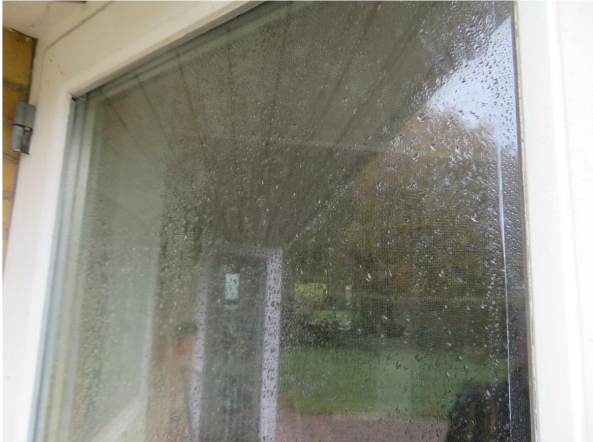
Result after spraying water on the reference window ... Résultat d'aspersion d'eau sur la fenêtre de référence
